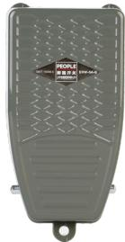
脚踏开关适用于交流50/60Hz，额定工作电压至380V，额定控制容量至300VA，约定发热电流至5A的电路中，用来频繁地接通和分断电路。
