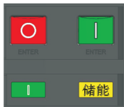
断路器合闸且已储能完毕状态
