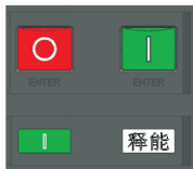
断路器合闸且无储能状态
