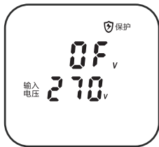
继电器保护：当继电器故障时，机器停止输出。
